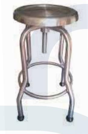
Fabricado estructura de tubo redondo de 1" cal. 18 de acero inoxidable, asiento fabricado de acero inoxidable cal. 16 con esparrago de 1" de acero inoxidable para dar ajuste de altura.
